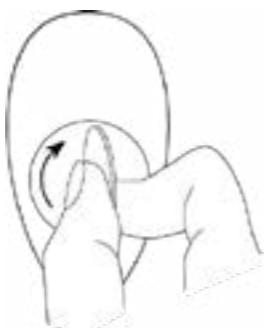
3. À l'aide de l'anneau porte-clés fourni ou d'une pièce de monnaie, fermez le couvercle de la batterie en le tournant dans le sens des aiguilles d'une montre.
