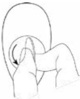
1. À l'aide de l'anneau porte-clés fourni ou d'une pièce de monnaie, ouvrez le couvercle de la batterie en le tournant dans le sens inverse des aiguilles d'une montre.
