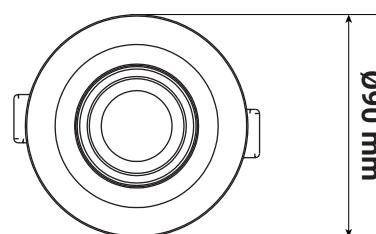
Perçage :  $\varnothing 68$  mm
