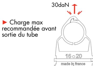
▶ Charge max recommandée avant sortie du tube
