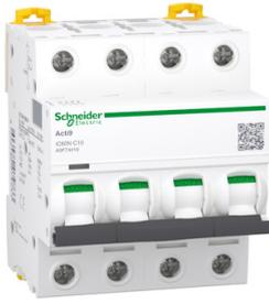
Disjoncteur, Acti9 iC60N, 4P, 10 A, courbe C, 6000 A (IEC 60898-1), 10 kA (IEC 60947-2)
