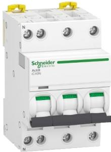
Disjoncteur miniature (MCB), Acti9 iC40N, 3P+N, 10 A, courbe C, 6 000 A (CEI/EN 60898-1), 10 kA (CEI/EN 60947-2)
