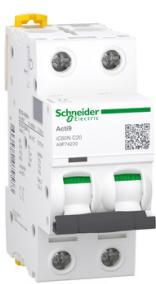
Disjoncteur miniature (MCB), Acti9 iC60N, 2P, 20 A, courbe C, 6 000 A (CEI/EN 60898-1), 10 kA (CEI/EN 60947-2)
