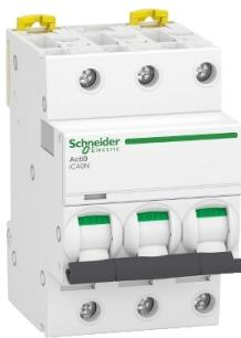
Disjoncteur miniature (MCB), Acti9 iC40N, 3P, 10A, courbe D, 6 000 A (CEI/EN 60898-1), 10 kA (CEI/EN 60947-2)
