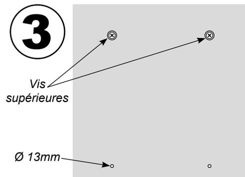
Percer les 4 trous d'un diamètre de 13mm. Insérer 4 chevilles dans les trous. Visser les 2 vis supérieures.
