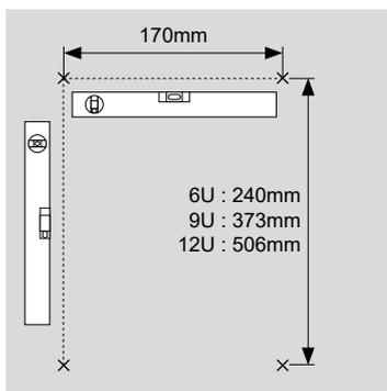
Tracer un trait horizontal sur le mur à l'aide d'un niveau. Marquer au crayon l'emplacement des 4 trous comme indiqué sur le schéma. L'entraxe horizontal est de 170mm quant à l'entraxe vertical il est de 240mm pour le coffret 6U, de 373mm pour le 9U et de 506mm pour le 12U.
